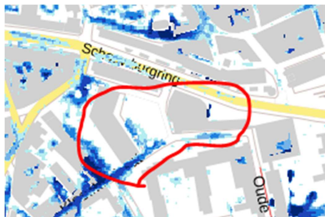
Schouburg zichtbaar met lichte wateroverlast bij kortdurende hevige neerslag voor het gebouw en bij de parkeergarage bron: Klimateffectatlas)
