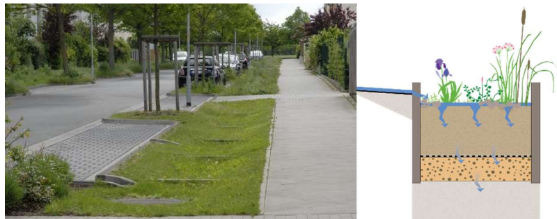
Voorbeeld en werking infiltratiestrook in smalle greppel
