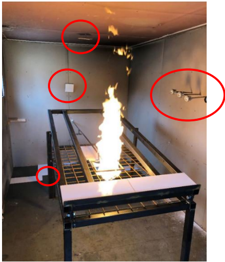
Figuur 2-1 Opstelling van de brandexperimenten in de container. Rood omcirkeld zijn de luchtstoffilters, en een deel van de posities van keramische tegels aan het plafond en de muur en op de vloer.
