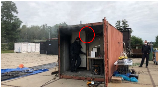
Figuur 3-7 Locatie van de luchtbemonstering in het voorportaal van de container. Lichte rook is zichtbaar in en voor het voorportaal.
