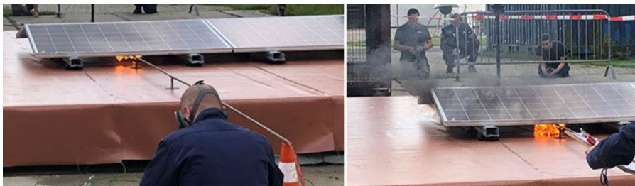
Figuur 4-1 De aanvang van de brandexperimenten in open lucht. Op de linker foto brandt de pvc-dakbedekking nog niet mee. Op de rechter foto brandt de pvc-dakbedekking. Op de linker foto is zichtbaar dat het glas al vervormt door hitte.
