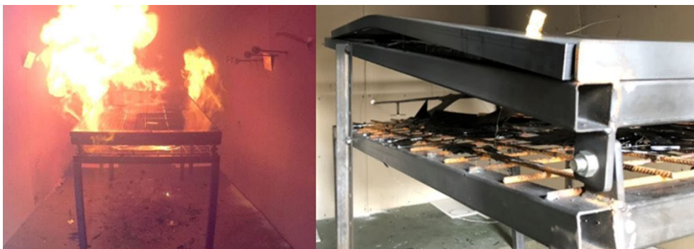
Figuur 3-4 Glas-glas paneel van experiment 3. Op de linker foto de steekvlam na explosie. De rechter foto toont het ontzette frame na afloop van het experiment. De rechte buis is onderdeel van de tafel, de kromgetrokken lijst is onderdeel van het zonnepaneel. De bovenste glasplaat van dit glas-glas paneel was na het experiment verbogen, maar intact.
