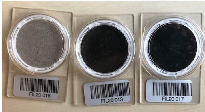
Figuur 4-3 Drie luchtbemonsteringfilters na bemonstering bij 2 brandexperimenten. Filter 20016 is beperkt aan rook blootgesteld.
