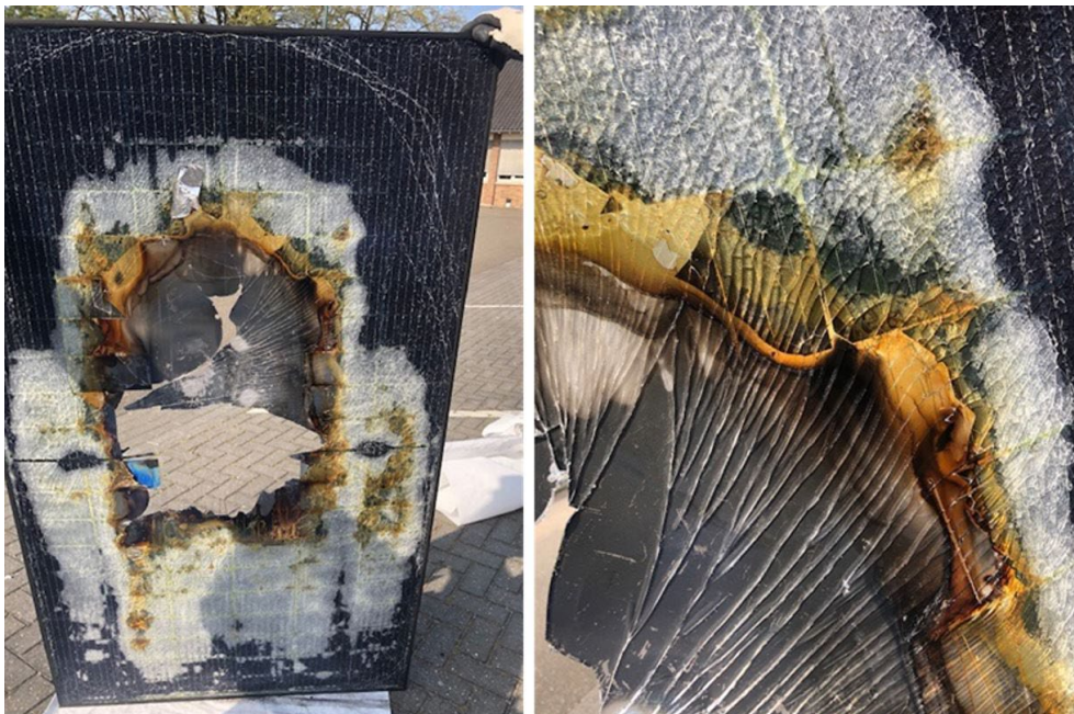
Figuur 3-6 Glasbreuk van panelen door transport na de experimenten. Links het paneel van experiment 5 en rechts een detail van dit paneel. Verschil tussen de locatie waar het paneel sterk verhit is en waar niet is duidelijk zichtbaar door breuk in scherven en verbrijzelen van glas.
