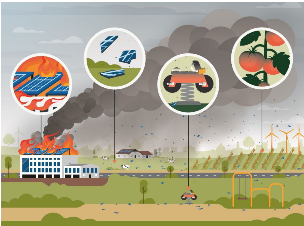
Figuur 1-3 Schematische weergave van de verspreiding en depositie van rook, roetdeeltjes, scherven en andere stukken verbrand materiaal bij een brand met zonnepanelen, en de mogelijke wijze van blootstelling aan deze depositie via landbouw of contact met vervuild oppervlak.
