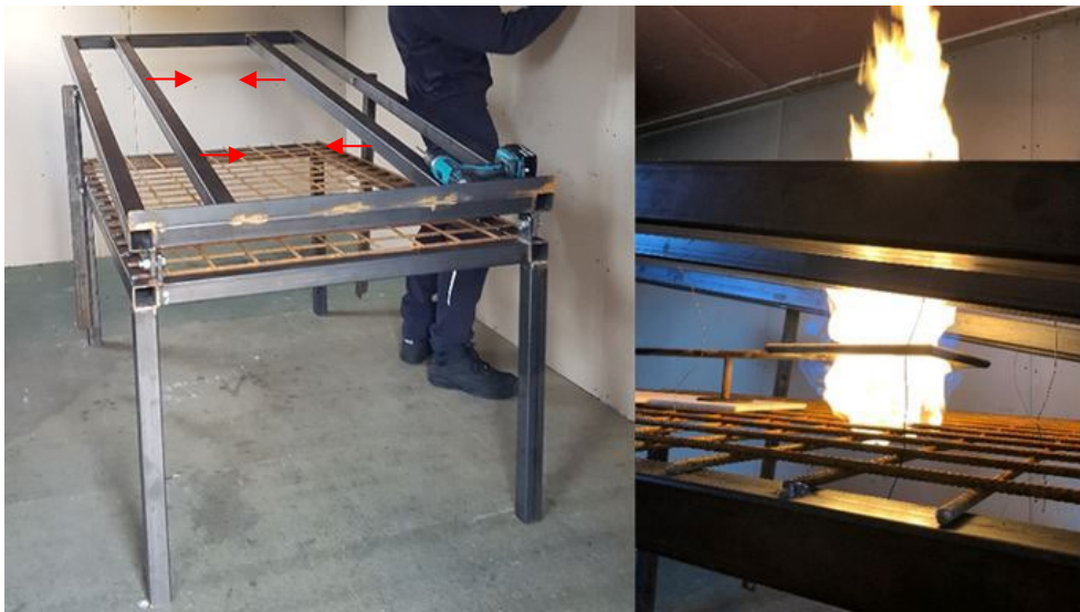
Figuur 0-3 Links: De tafel waarop de experimenten worden uitgevoerd. De koppen van de rode pijlen geven een indicatie waar de thermokoppels aan de onderzijde van het paneel zich bevonden. Deze waren bevestigd om de stalen balk waar de pijlen beginnen. Rechts: de vlam zonder paneel bij een nulmeting.
