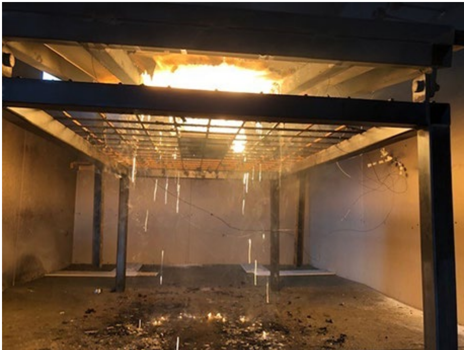
Figuur 3-2 Brandende druppels zijn bij experiment 6 na 7 seconden zichtbaar en de druppels blijven direct langer dan 5 seconden op de vloer doorbranden.
