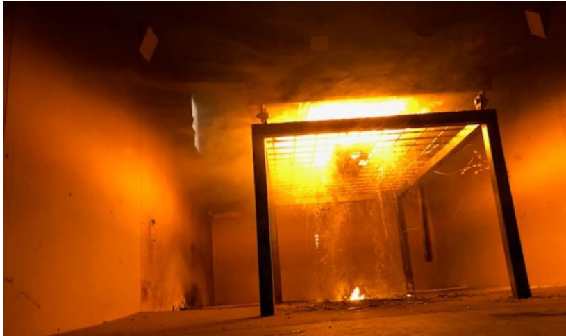
Figuur 3-3 Brandende druppels die op de grond blijven branden bij een glas-glas kristallijn paneel van experiment 4. Deze druppels verschenen na twee minuten verhitting. De glasplaat aan de onderzijde van het paneel is daarvoor gebroken en naar beneden gevallen.
