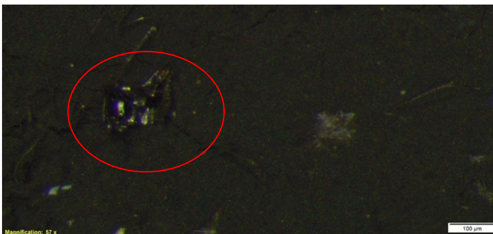
Figuur 5-9 Macroscopische vergroting (57x) van een silicium schurf uit het experiment in de open lucht, in een luchtfilter dat zwaar belast is door rook. De schaalbalk rechts is 100 µm.
