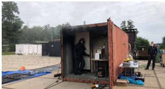
Figuur 0-2 De container tijdens een experiment op dag twee. De brandweerman staat in het voorportaal. De deur gaat hier op een kier en de onderzijde van de deur heeft een opening van +/- 15 cm. Linksboven in beeld een indruk van de rook die na openen van de deur wegstroomde.
